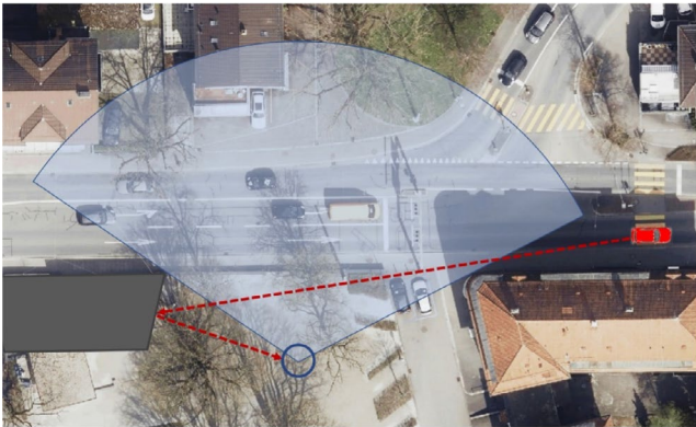
Aspektwinkel und Schallquelle (rot), die wegen der seitlichen Spiegelreflexion zusätzlich gehört wird.
