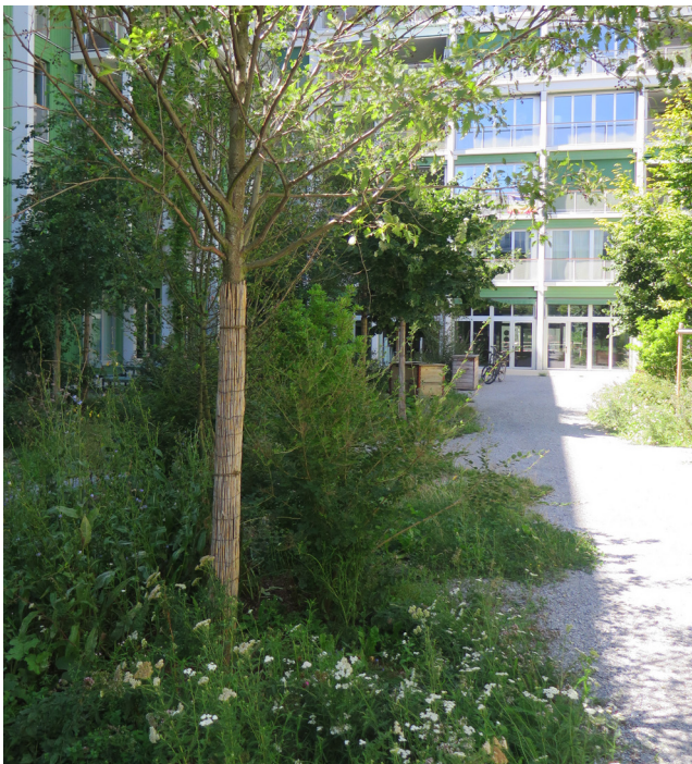
Begrünter Innenhof der Wohnüberbauung Lokwerk in Winterthur. Stauden und Bäume sowie offenporige Splittwege verbessern die akustische Qualität. Bild: Thomas Gastberger
